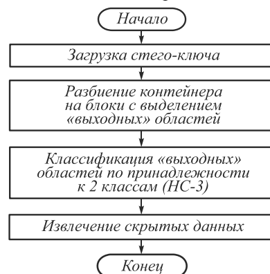
Рис. 4. Обобщённая схема работы алгоритма извлечения данных
