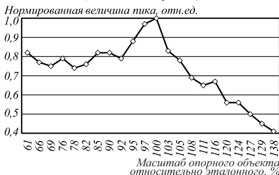
Рис. 6. График зависимости величины корреляционного пика от масштаба опорного объекта (для объекта с рис. 2б)
