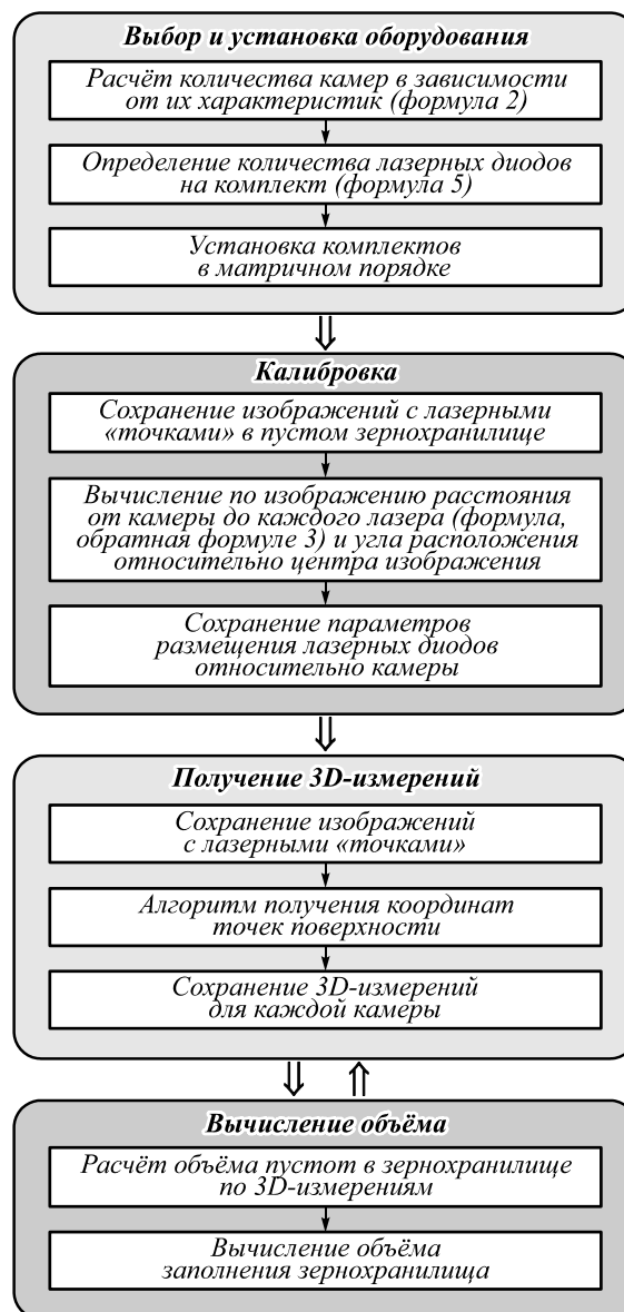
Рис. 4. Логическая схема процесса автоматической регистрации 3D-измерений в зернохранилище
