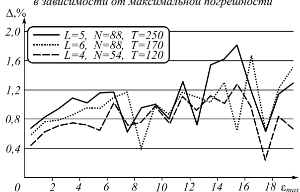
Рис. 10. Выигрыш контекстного интерполятора с модифицированной областью оценивания у усредняющего интерполятора в зависимости от максимальной погрешности для первого тестового сигнала
