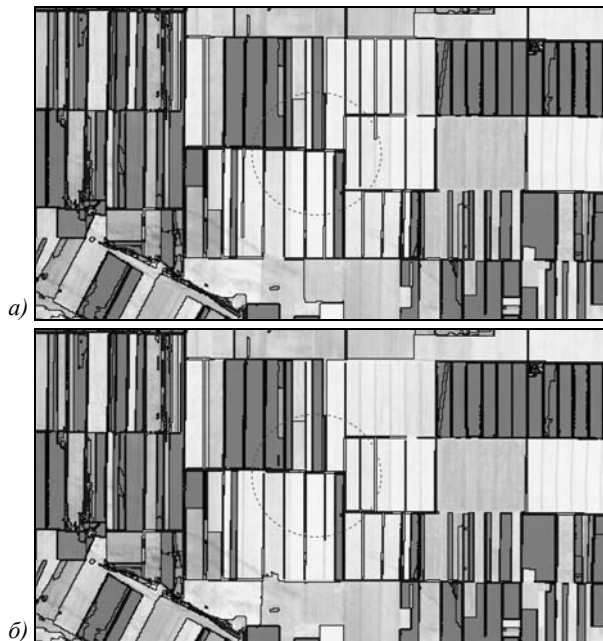
Рис. 6. Границы сегментов (черные линии), полученные на основе неизменных данных (а) и после создания искусственного пропуска в одном из признаков (б), область пропущенных значений обозначена пунктирной линией, на фоне – изображение признака, в котором была создана область пропущенных значений
